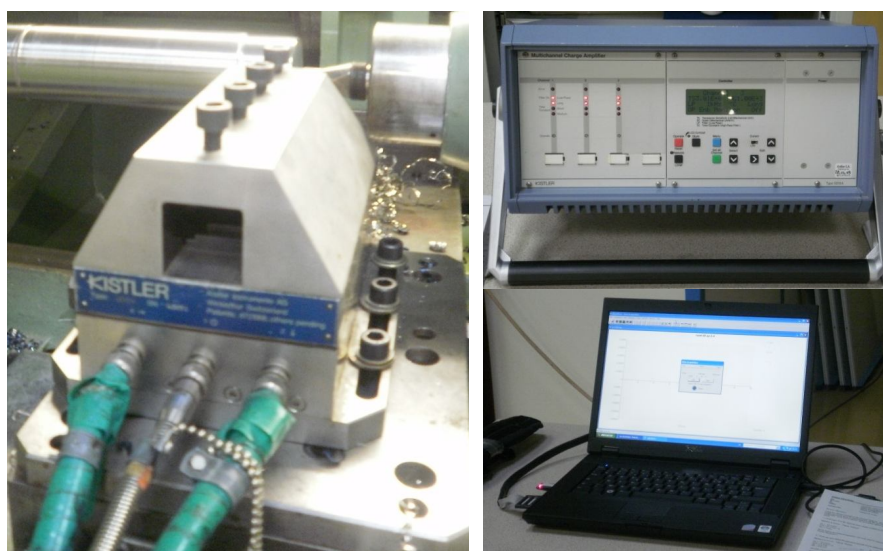
Рис. 2. Установка для измерения силы резания
