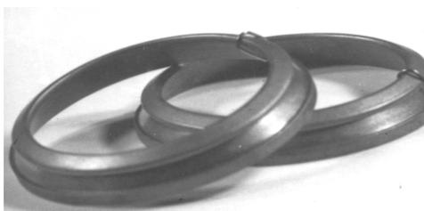
Рис. 1. Общий вид пары «кольцо-скоба» для исследований момента силы трения и износа скобы (вариант А)
