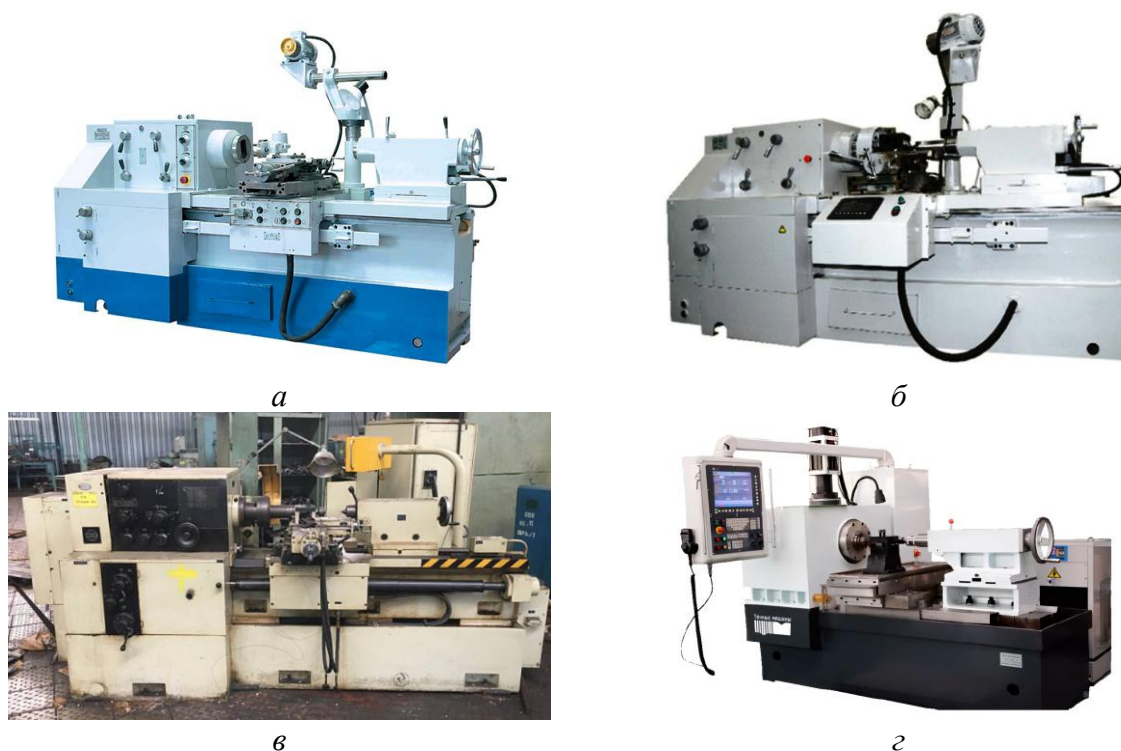
Рисунок 1. Токарно-затыловочные станки: а – 1Е811; б – 1Е812; в – ДН-250/4; г – станок с ЧПУ ТМ НТМ-Л
