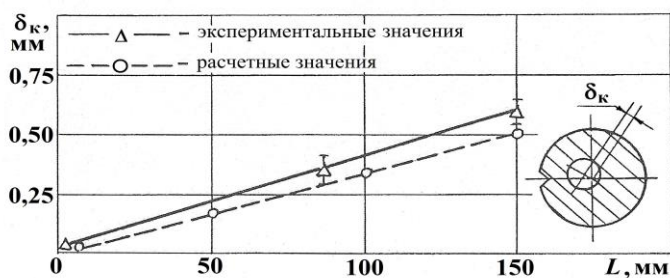
Рисунок 3. Зависимость увода сверла от глубины обрабатываемого отверстия: 1X12H2BMФ – P9K5; d = 10 мм; s_0 = 0,14 мм/об
