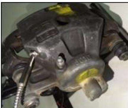
Рисунок 3. Система капельного охлаждения тормозного механизма дисково-колодочного типа
