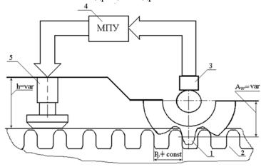
Рисунок 6. Функциональная схема адаптивной опорной системы очистного комбайна
