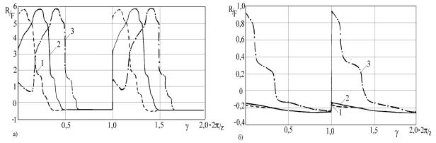
Рисунок 6. Графики изменения радиального усилия в зубчатом зацеплении БСП очистного комбайна КА: а) при номинальном межцентровом расстоянии; б) при максимальном межцентровом расстоянии Aw и шаге зубьев рейки Pp; 1) минимальном; 2) номинальном; 3) максимальном. R/F - соотношение радиального к тяговому усилию зацепления;  $\gamma$ - угол поворота приводного колеса; Z – число зубьев приводного колеса
