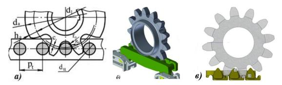
Рисунок 3. Конструктивные особенности реек движителей БСП: а) цевочная, б) зубчатая в) зубчатая повышенной подвижности из элементарных зубьев
