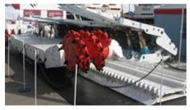
Рисунок 2. Вид очистного комбайна с БСП
