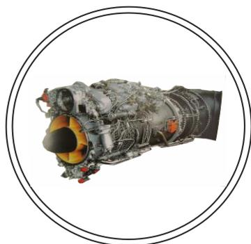
Рисунок 1. Общий вид ГТД модели ТВ3-117.
