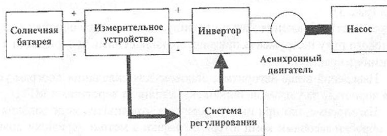
Рис. 1. Структура солнечного частотно-регулируемого асинхронного электропривода водяного центробежного насоса.
