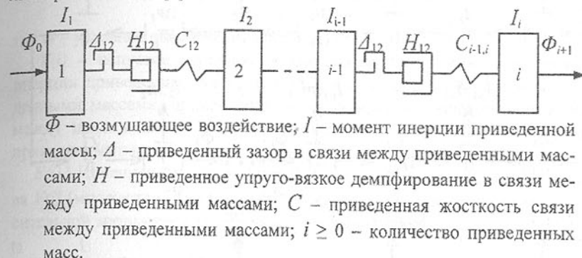
Рис. 1. Эквивалентная схема многомассовой рядной колебательной технической системы.
