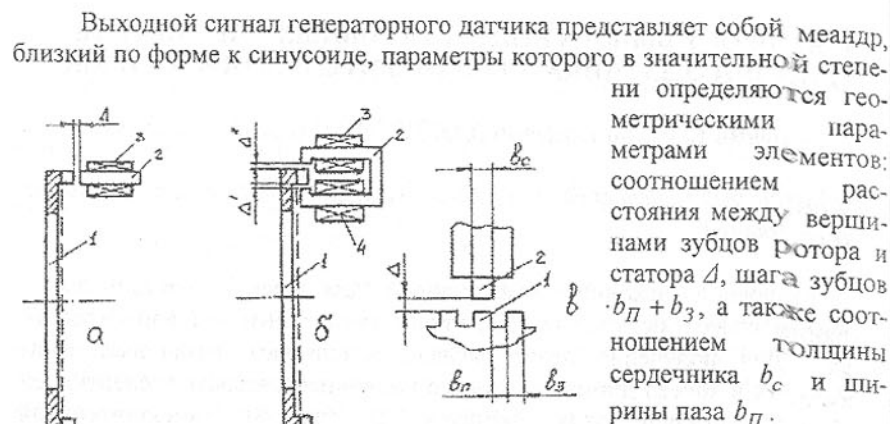
Рис. 1. Конструктивные схемы индукционных датчиков: а – с постоянным магнитом; б – с электрическим намагничиванием; в – геометрические параметры датчиков
