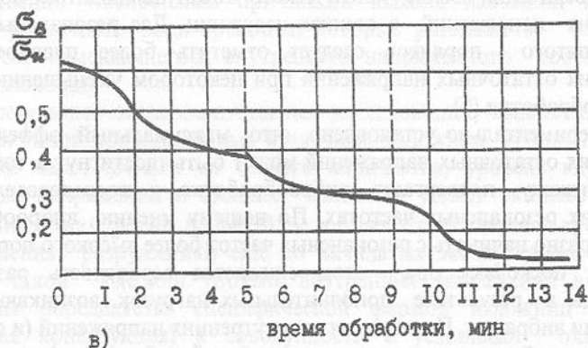
Рисунок 1 - Изменение внутренних остаточных напряжений в стенках изложницы в процессе виброобработки:
