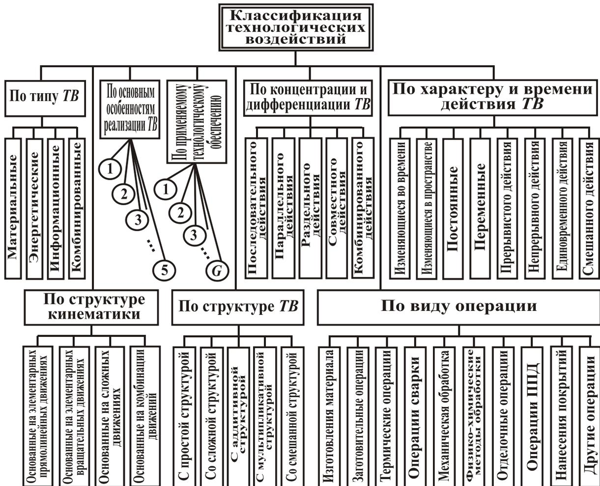
Рис. 5. Классификация технологических воздействий в функционально-ориентированных технологиях
