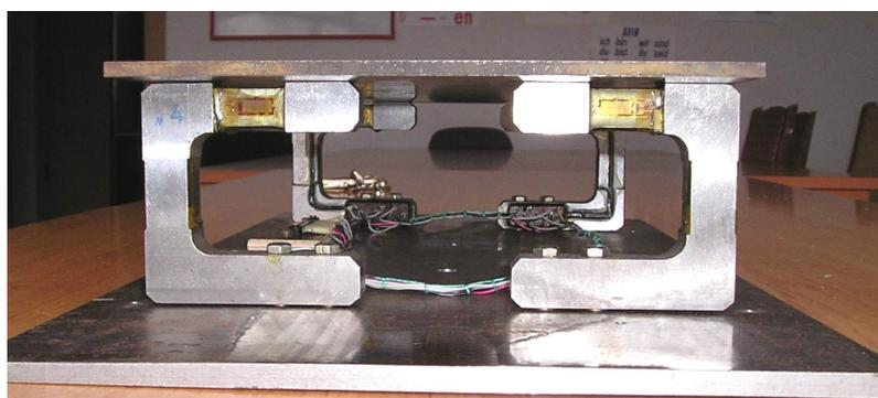
Рис. 5. Вид тензометрического стола с С-образными датчиками силы
