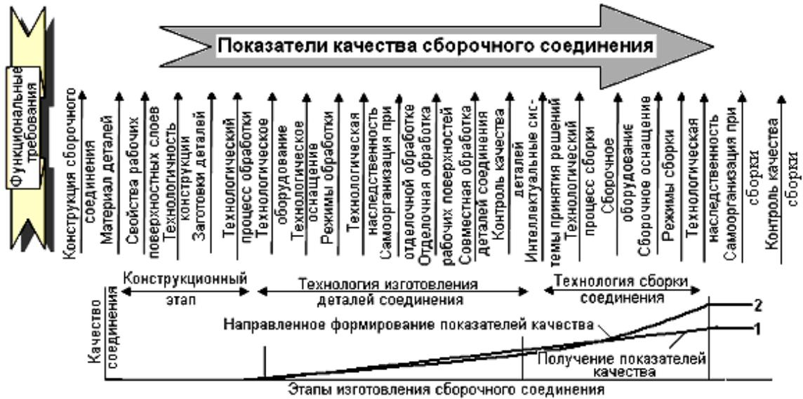
Рис. 1. Механизм направленного формирования качества собираемых изделий
