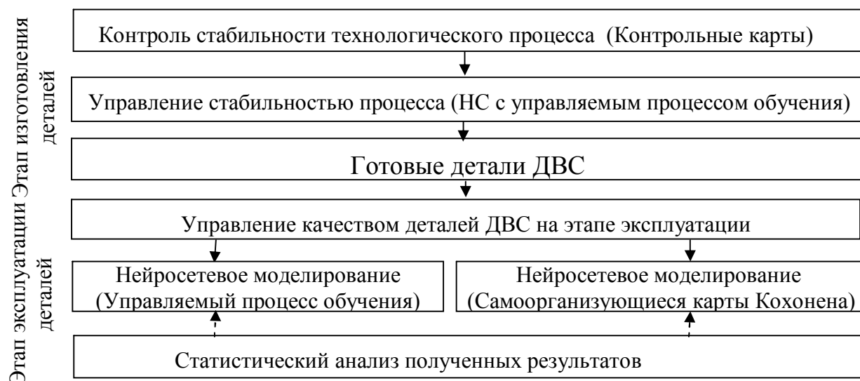
Рис.1. Алгоритм информационной поддержки управления качеством деталей ДВС
