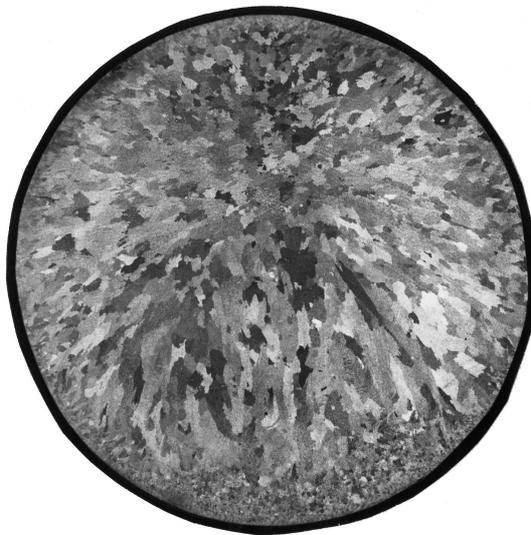
Рис.4. Макроструктура слитка БрО5Ц12С5 при оптимальном режиме (?1)
