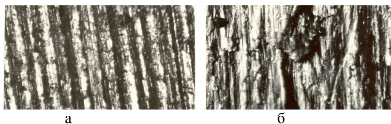
Рис. 5. Фотографии обработанной поверхности при резания стали 45 инструментом из Т5К10 а-в кислороде, б- в аргоне
