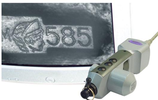
Рис.4. Микроскоп с монитором, на котором показано исследуемое изображение
