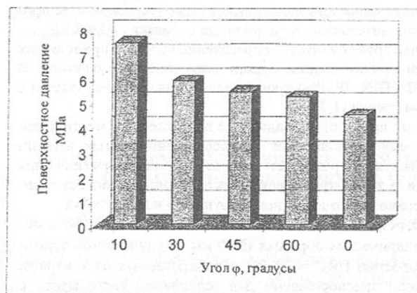
Рис. 3. Влияние угла \phi на сопротивляемость поверхности образца задиранью
