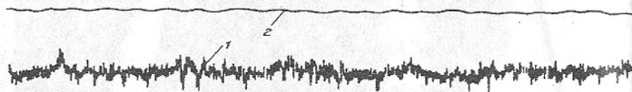
Рис. 22. Осциллограмма крутящих моментов на валах волнового редуктора привода поворота передвижного миксера МП-600 АС, при частоте вращения входного вала \omega_1 = 1,667 \text{ с}^{-1} : 1 – крутящий момент на входном валу; 2 – крутящий момент на выходном валу M_2 = 2,5 \cdot 10^5 \text{ Н} \cdot \text{м}
