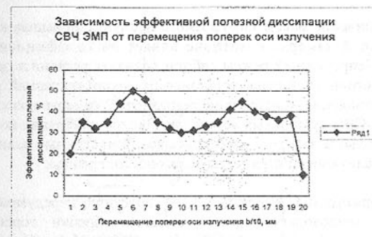
Рис. 2. Зависимость эффективной полезной диссипации микроволновой энергии от перемещения поперек оси излучения.
