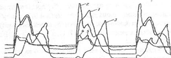
Рис. 3. Осциллограмма деформации локализованных элементов зуба жесткого колеса при нагрузочном моменте M_2 = 3 \cdot 10^5 \text{ Н} \cdot \text{м} и частотой вращения входного вала \omega_1 = 1,667 \text{ с}^{-1}
