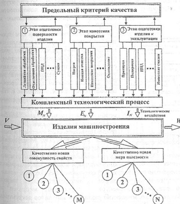
Рис. 1. Системная модель общего подхода в создании комплексного технологического процесса изготовления изделий с покрытиями на базе предельного критерия качества
