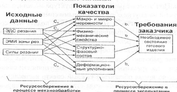
Рис. 1. Переход от диагностических сигналов к требуемому качеству изделия
