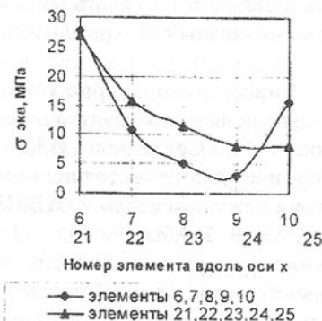
Рис. 4. Распределение напряжений параллельно поверхности связки
