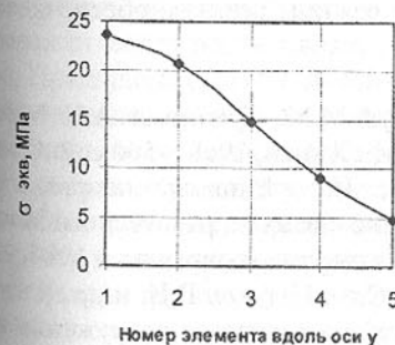
Рис. 3. Распределение напряжений вдоль оси зерна
