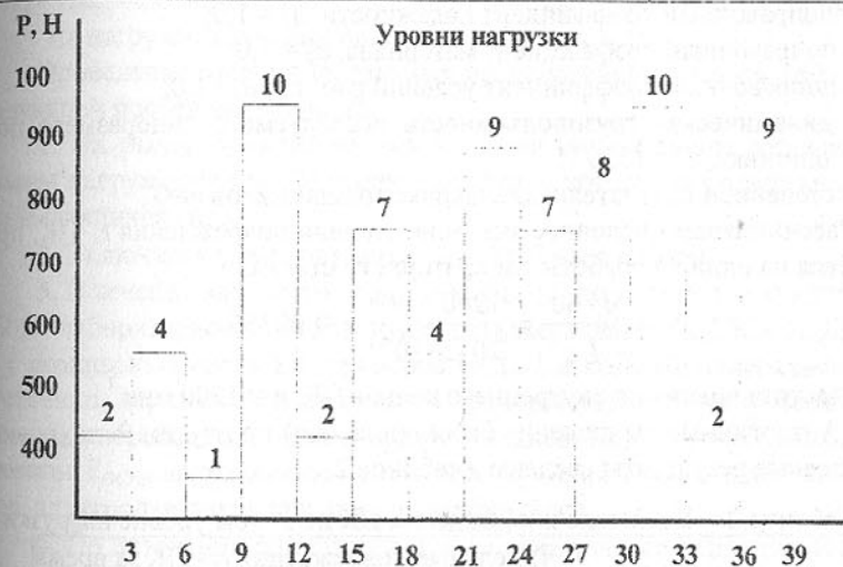
Рис. 2. Диаграмма нагружения ПК в 1-ом эксперименте
