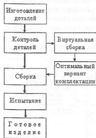
Рис. 2. Виртуальная сборка в серийном производстве
