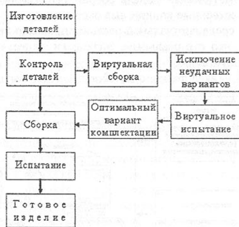
Рис. 3. Виртуальная сборка и виртуальное испытание в серийном производстве
