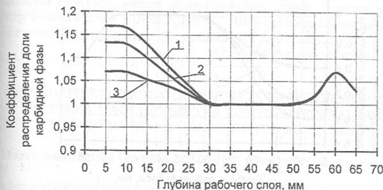
Рис. 4. Распределение доли карбидной фазы по глубине рабочего слоя при различной толщине слоя насадки (1 – h_{накл}=2,3 мм 2 – h_{накл}=2,8 мм 3 – h_{накл}=5,5 мм).
