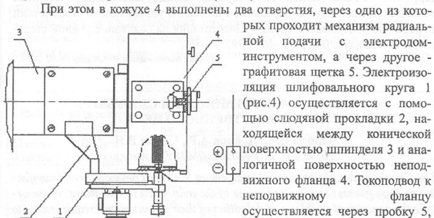
Рис. 3. Модернизация плоскошлифовального станка мод. 3Д711АФ11
