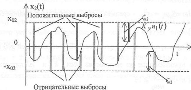
Рис. 2. График сигнала x_2(t) на выходе масштабирующего усилителя учётом нелинейности передаточной характеристики
