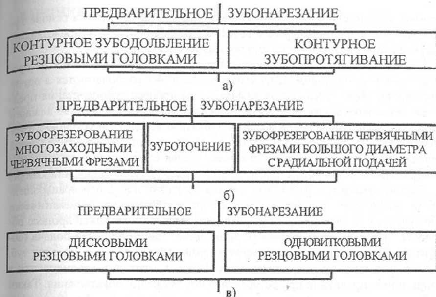
Рис. 2. Варианты прогрессивных технологических схем зубонарезания цилиндрических колес
