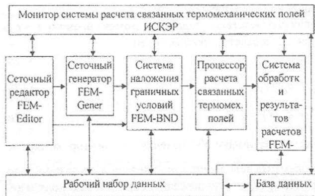
Рис.1. Общая структура системы расчета связанных термомеханических полей ИСКЭР
