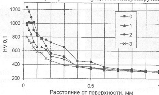
Рис. 4. Распределение микротвердости стали 38ХМЮ, азотированной методом "nitreg" при различных вариантах упрочнения взрывом: 0- без упрочнения; 1, 2, 3 – номера I серии опытов в соответствии с данными таб. 1.
