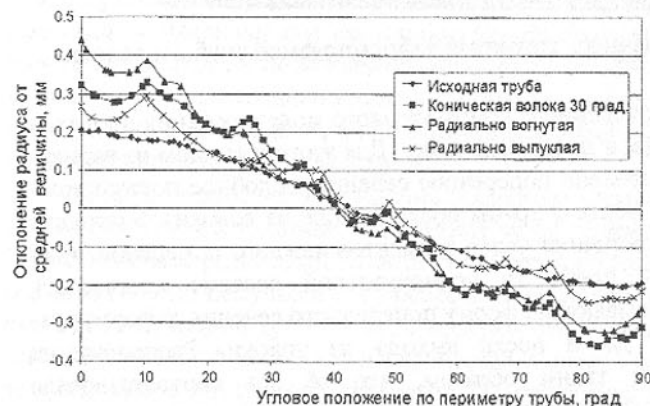
Рис. 3. Распределение отклонения внутреннего радиуса трубы от его средней величины по периметру исходной трубы и после волочения через волокна различной формы
