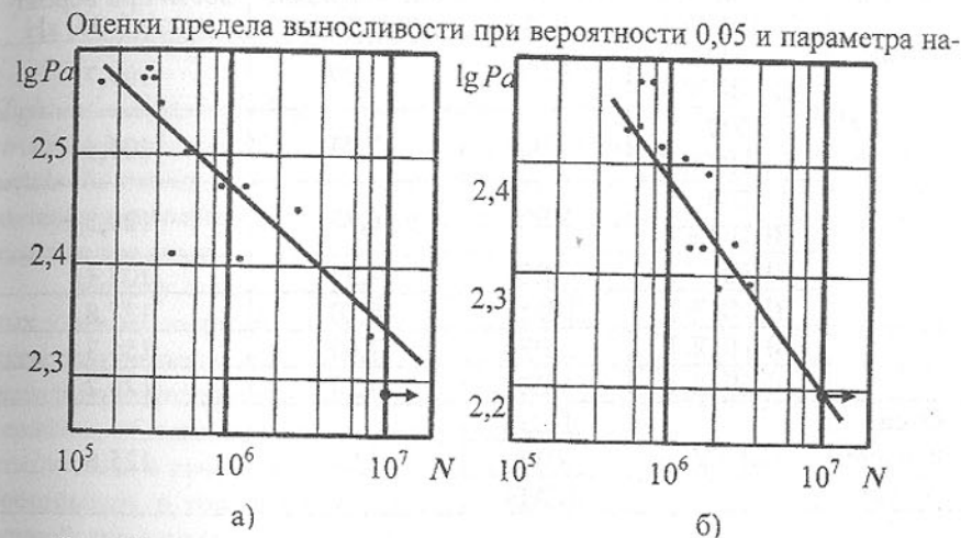
Рис. Кривая усталости по трещинообразованию отслуживших 30 лет надрессорных балок (а) и боковых рам (б): P_a – амплитуда цикла нагрузки; N – число циклов до появления первой макротрещины
