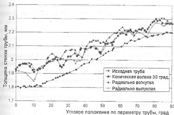
Рис. 4. Изменение толщины стенки по периметру трубы
