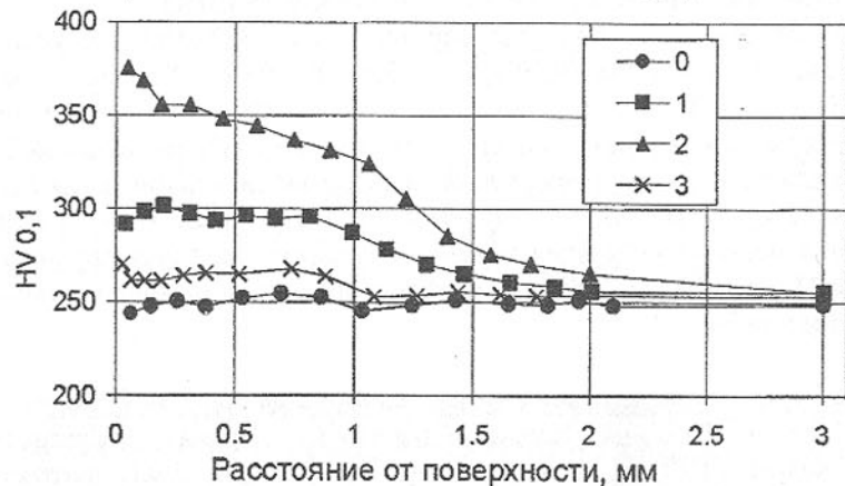
Рис. 1. Распределение микротвердости стали 38ХМЮ первой серии образцов после деформационного упрочнения взрывом
