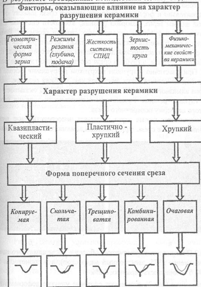
Рис.1. Классификация разрушения керамики и форм поперечного сечения среза при алмазном шлифовании
