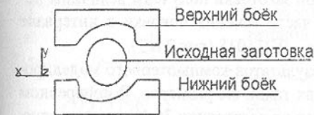
Рис.1. Схемаковки заготовки трапециодальными бойками
