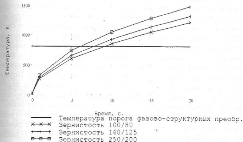
Рис. 2. Влияние времени обработки на температуру на поверхности резания при шлифовании неподвижного образца по упругой схеме.
