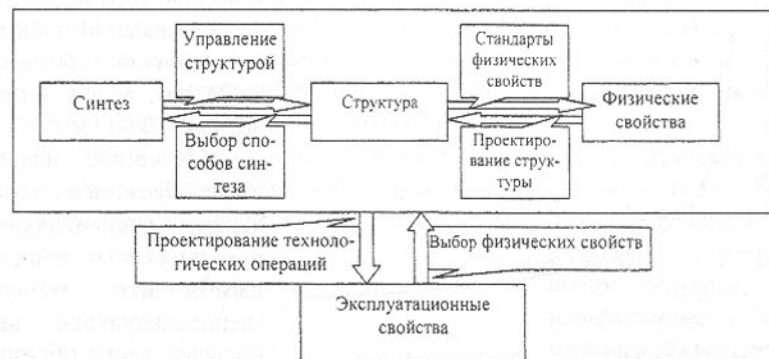
Рис.5. Схема формирования эксплуатационных показателей изделий из керамики
