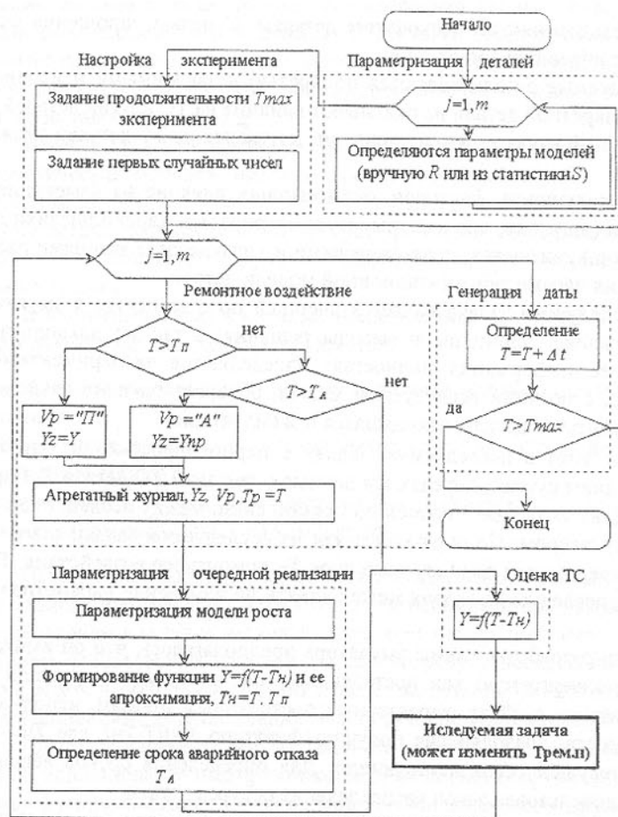
Рис. 1. Схема эмулятора изменения ТС деталей при эксплуатации.
