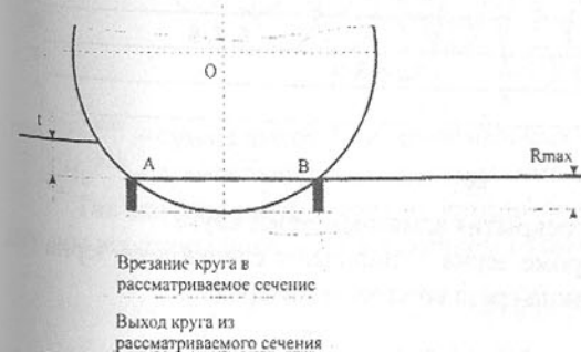
Рис. 2. Расчетная схема плоского шлифования периферией круга
